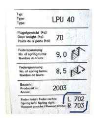
NB : Sur les portes HORMANN et TUBAUTO, les deux ressorts sont généralement différents (exemple : un L702 et un R703).
