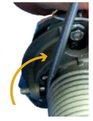
La goupille doit être sortie au maximum. Vous pouvez alors retirer le ressort de l'arbre.
